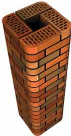
Колона на прикладі фасонної цегли Ф1
