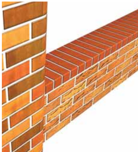
Накривка на прольоти парканів на прикладі цегли Пр 1/2
