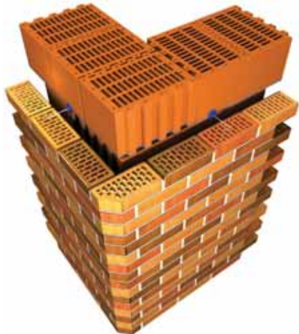
Кут будинку 90° на прикладі фасонної цегли Ф2
